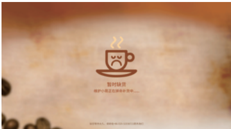
8、故障 设备故障，机器故障、产品售完、无网络、大门未关这四种状态中任何一种状态都会显示故障界面，并且会将该状态上报服务器。
