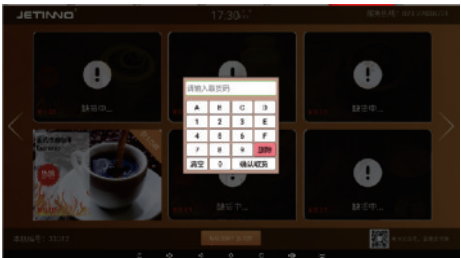
7、取货码 点击页面下方正中间按钮可以弹出取货码输入框，输入取货码后，“确认取货”验证成功后会直接跳到制作产品页面。验证失败或超时会在取货码输入框上方提示。点击输入框外部区域可以关闭输入框并取消订单。
