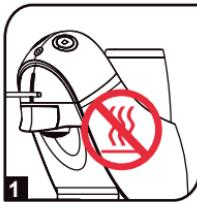
1 La máquina apaga el hervidor y la bomba cuando hay un error NTC.
