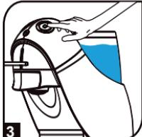
Pulse cualquier tecla de volumen para recuperar el modo de espera y llenar el depósito, pulse cualquier tecla de volumen de nuevo para iniciar la máquina.
