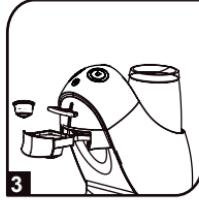
Öffnen Sie den Griff und tauschen Sie sie gegen eine neue Kapsel aus. Drücken Sie eine beliebige Volumentaste, um in den Standby-Modus zu wechseln.
