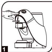
1 Prima o botão de alimentação para colocar manualmente a máquina no modo de Poupança de energia.
