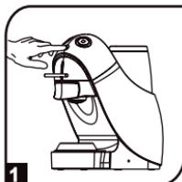
1 Appuyez sur la touche marche/arrêt pour mettre la machine en mode économie d'énergie manuellement.
