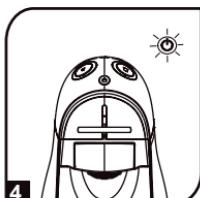
4 Перемикач живлення загортається зеленим світлом і блимає з частотою 1 Гц, при цьому загортається кнопка об'єму чашки (система розпочинає розігрівання)
