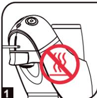
1 A máquina desliga o fervedor e a bomba quando existe um erro de NTC.
