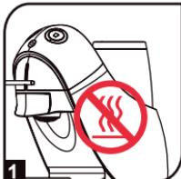
1 Lorsque la machine a fonctionné/ préparé des cafés en continu avec 2 litres d'eau, le système cesse de fonctionner et émet un avertissement sonore (si la machine n'a pas fonctionné/ préparé de café en continu ou si elle est en veille depuis plus de 5 minutes, le recommence à compter à partir de zéro)
