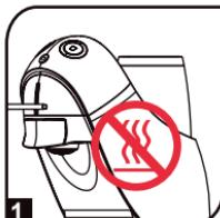
1 Апарат вимикає бойлер і насос у разі збюю датчика з негативним температурним коефіцієнтом.
