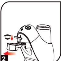
2 Levante o manípulo e retire o suporte para cápsulas para inserir a cápsula. Coloque o suporte para cápsulas na respetiva posição e pressione o manipulo para baixo.
