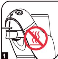
1 Beim Auftreten eines NTC-Fehlers nimmt die Maschine den Kocher und die Pumpe außer Betrieb.
