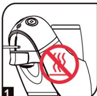
1 En cas d'erreur NTC, la machine éteint le chauffe-eau et la pompe.
