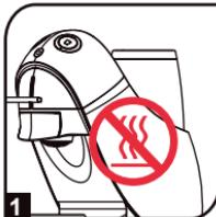
1 Wenn die Maschine mit 2 Liter Wasser ununterbrochen betrieben wurde, hält das System an und gibt eine Warnmeldung ab (wenn die Maschine nicht kontinuierlich funktioniert/gebrüht hat oder länger als 5 Minuten pausiert, startet die Maschine die erneute Zählung).
