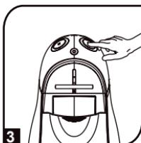
Prima o botão longo uma vez, a temperatura da máquina sobe 1 °C (prima mais uma vez para a temperatura da máquina subir 2 °C). É possível aumentar um máximo de 4 graus através do mesmo método.
