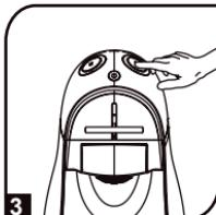
3 Drücken Sie die Lungo-Taste einmal, und die Maschinentemperatur erhöht sich um 1 °C (bei erneutem Drücken steigt die Maschinentemperatur um 2 °C). Auf die gleiche Weise kann die Temperatur um maximal 4 Grad angehoben werden.
