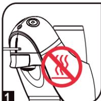
1 La macchina arresta sia la caldaia sia la pompa se c'è un errore della NTC.
