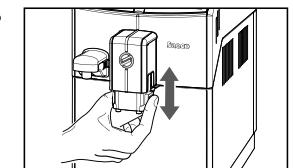
Висоту носика подачі можна відрегулювати під розміри чашок, які ви хочете використовувати.
