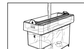
8 Наповніть свіжою питною водою до рівня, визначеного символом «CALC CLEAN».
