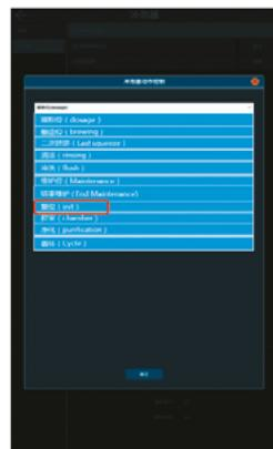
Вставте впускну трубку блока заварювання у швидкорозчинне з'єднання до упору; натисніть у нижньому правому куті екрана, натисніть "Налаштування" -> "Блок заварювання" -> "Управління роботою блока заварювання" -> "Скидання". Після закінчення роботи блока заварювання, на екрані буде відображений режим очікування.
