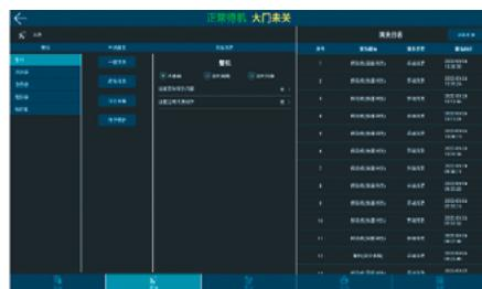
Відкрийте дверцята, відкрийте блакитний важіль зливання, введіть пароль у меню, від'єднайте машину від джерела подачі води або від'єднайте з'єднувальну трубку насоса, натисніть у нижньому правому куті "Чищення", натисніть "Спорожнити бойлер". Зачекайте п'ять хвилин, закрийте блакитний важіль зливання, закрийте дверцята машини і вимкніть живлення машини.
