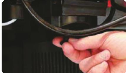
Від'єднайте роз'єм трубки на дні блока заварювання чаю
