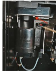
Два напрямні колеса на дні блока заварювання повинні потрапити у два напрямні пази напрямної блока заварювання. Два напрямні колеса блока заварювання потрібно поставити у напрямні пази, заштовхнути блок заварювання назад до клацання. Натисніть на замок всередину пальцями, щоб переконатися, що він замкнений.
