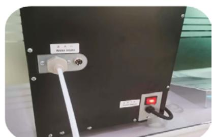
Передбачено два способи приєднання до джерела води – занурюваний насос і пряме підключення до водопроводу.
