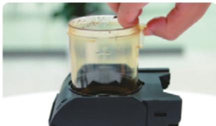
Витягніть стакан фільтра блока заварювання
