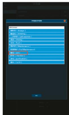
Вставте впускну трубку блока заварювання у швидкорозімне з'єднання до упору; натисніть у нижньому правому куті екрана, натисніть "Налаштування" -> "Блок заварювання" -> "Управління роботою блока заварювання" -> "Скидання". Після закінчення роботи блока заварювання, на екрані буде відображенний режим очікування.
